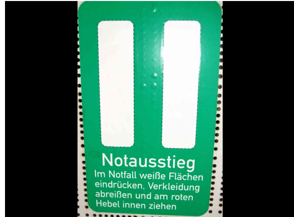
Decken - Notausstieg Im Notfall weiße Fläche eindrücken, Verkleidung abreißen und am roten Hebel nach innen ziehen
